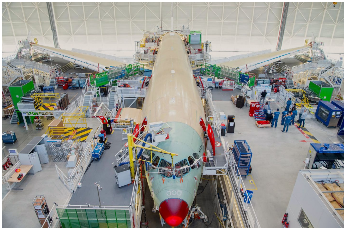
Air Francen A350-900 kokoonpanolinjastolla. Kuva: Airbus/Master Films/Hervé Goussé.
