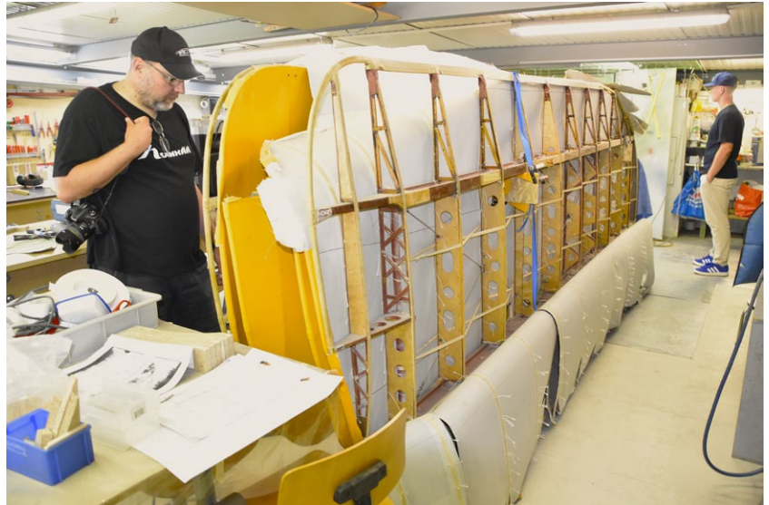
AMPA:n pajalla on restauroitavana Australiassa vuonna 1942 rakennettu De Havilland DH-82A Tiger Moth.
