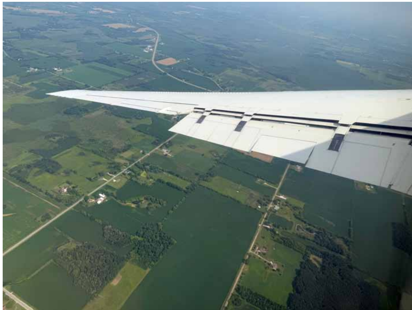
Ei slateja eikä lentojarruja, niinpä lähestymisprofiili on suunniteltava huolella.
