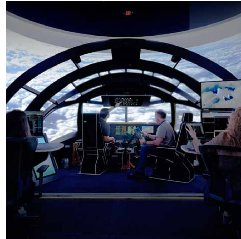
Avioniikkalaitteistojen ja -ohjelmistojen toimivuuden validointi tapahtuu integraatiotestauslaitoksessa (ITF). Geometrisesti tarkkaan ohjaamoon perustuva ITF on varustettu vastaavalla johdotuksella kuin lentokoneessa ja se saa virran lentokonetasoisesta sähköjakelujärjestelmästä.
