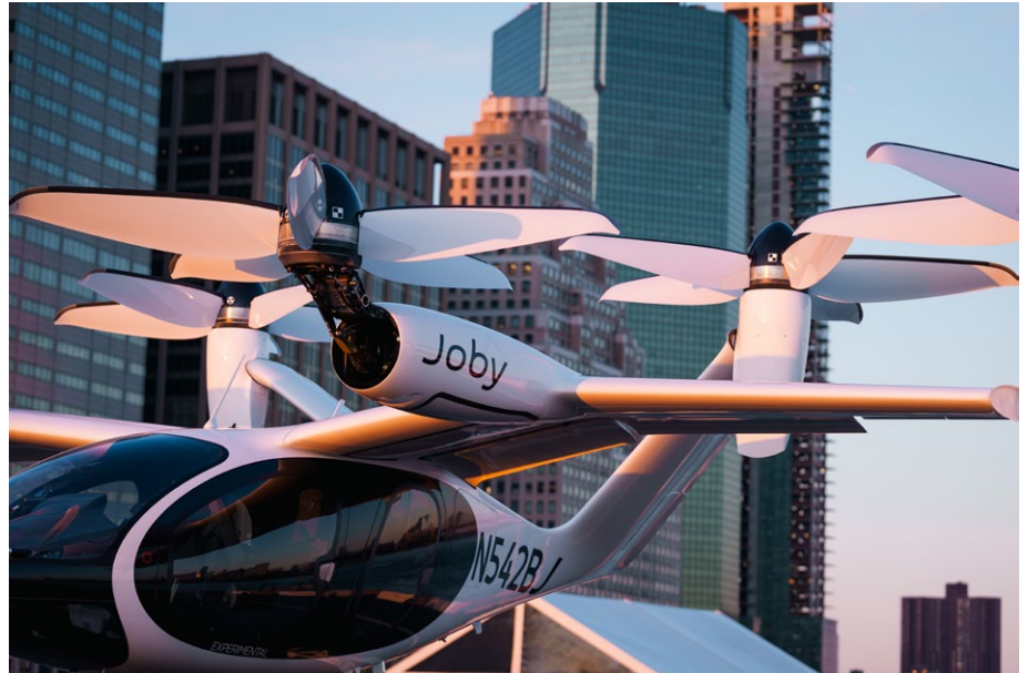
Jobyn kääntyvä moottorirakenne. Kuva: Joby Aviation.
