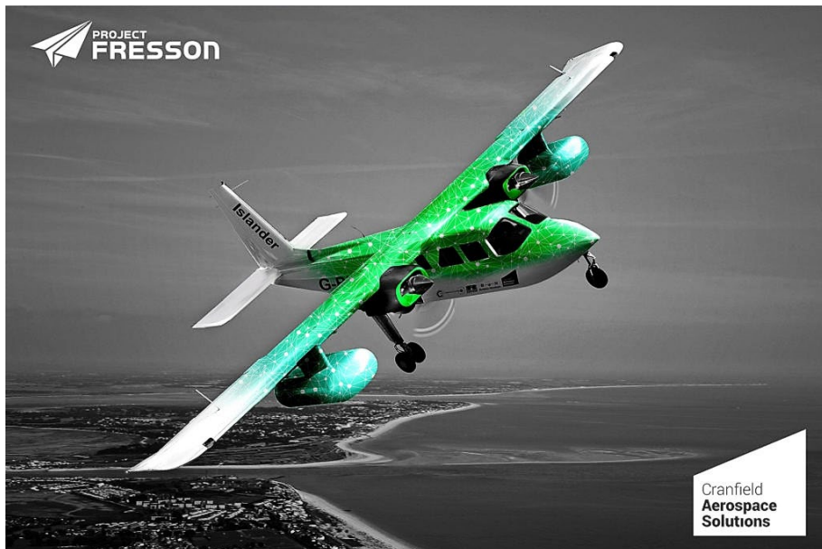
Cranfield Aerospace Solutionsin näkemys nestemäisellä vedyllä käytettävästä Britten-Normander Islanderista, jossa vetytankit sijoitettaisiin siipien alle. Kuva: Cranfield Aerospace Solutions
