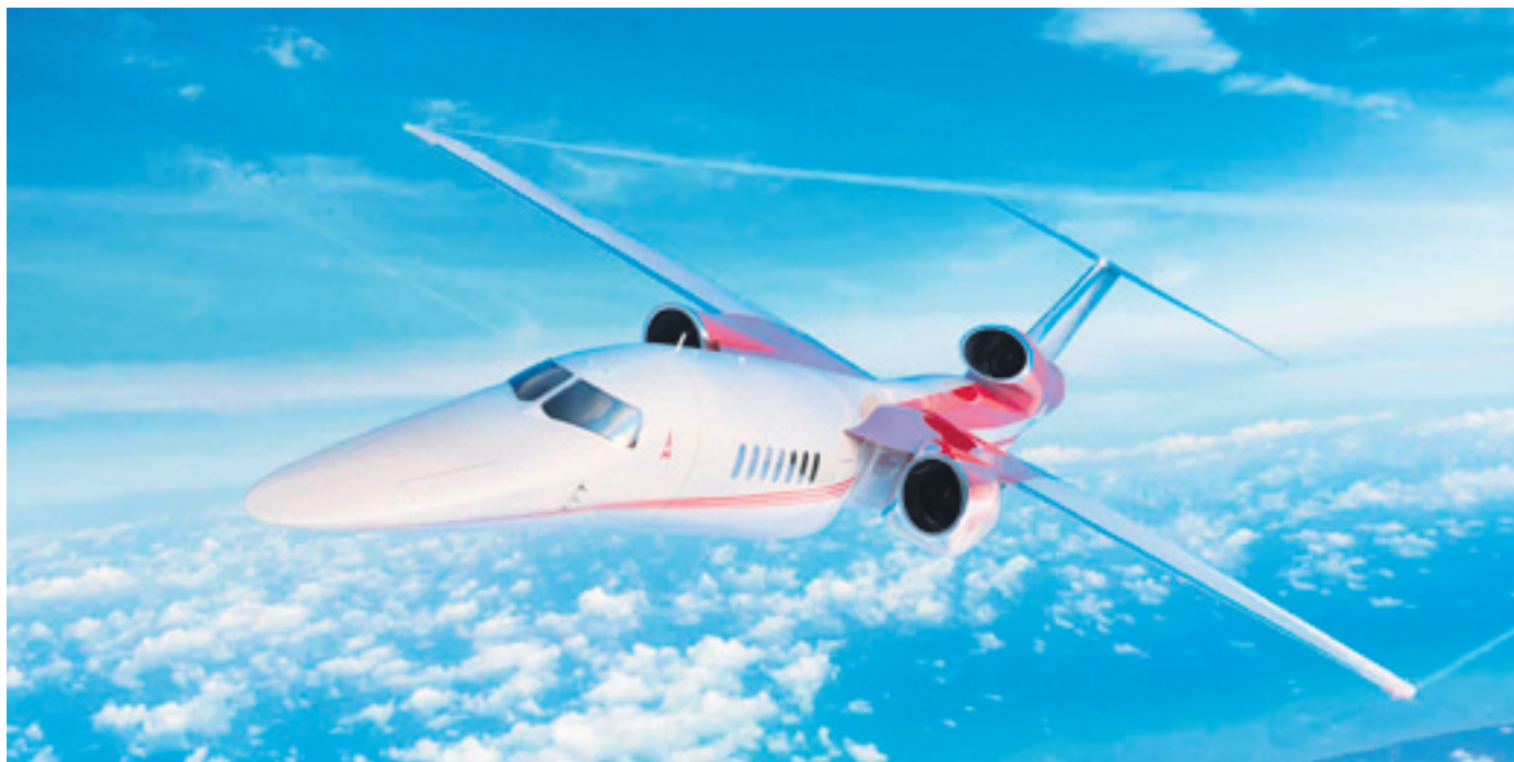
Toinen suunnitteluversio oli yltäso ja moottorit oli siirretty siipien alle. Kuva: Aerion
