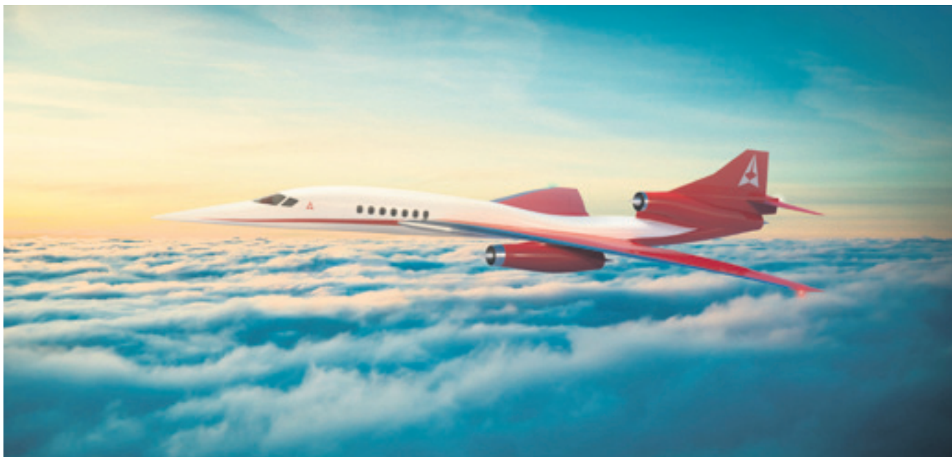
Viimeinen suunnitteluversio näyttää ihan eri koneelta deltasiipineen ja kavennettuine takarunkoineen. Kuva: Aerion
