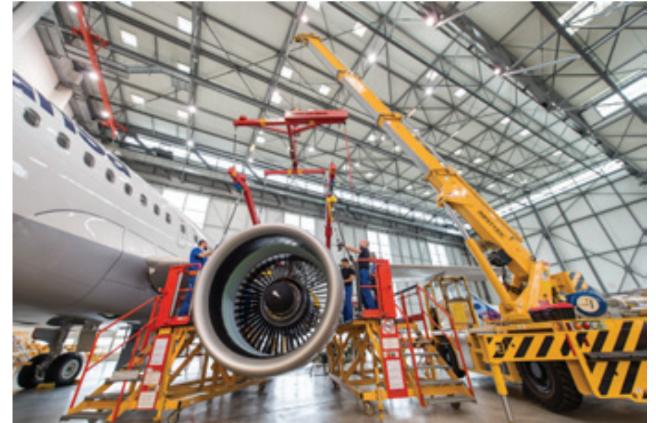
Lufthansan tekniikka vaihtaa A320neo:n pieneksi murheenkryyniksi osoittautunutta Pratt & Whitney 1100G-GTF moottoria. Kuva: Lufthansa
