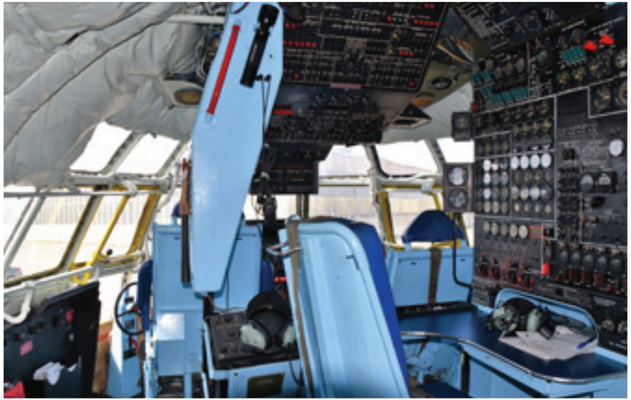
↓ C-97-koneen ohjaamo on varsinainen "glass cockpit" & "instrument jungle" – huomaa kapteenin iso rullausratti ikkunan vieressä. kuva Heikki Tolvanen
