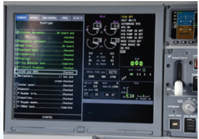
Keskinäytöllä on nähtävissä sähköinen checklista muun olennaisen tiedon lisäksi. Kuva: Heikki Tolvanen
