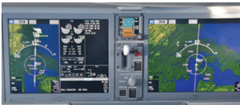
CS300:n muunneltavat näytöt ja erinomaisen informatiivinen navigaationäyttö. Kuva: Heikki Tolvanen
