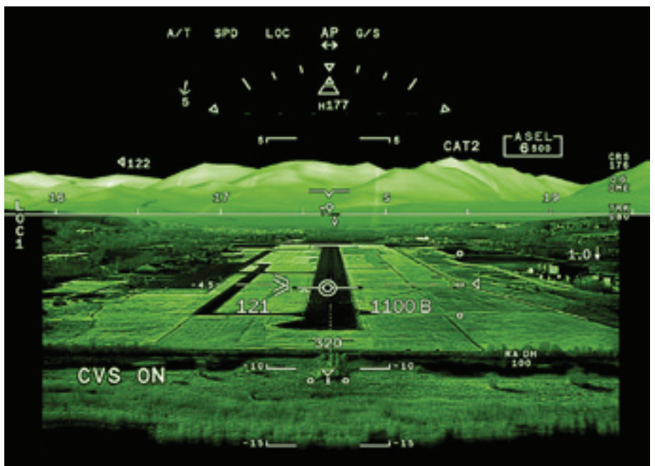
EASA:n ja FAA:n Falcon 2000S- ja LHX-liikokoneisiin sertifioima Dassault FalconEye Combined Vision Systemin selkeä näyttö. Kuva: Dassault
