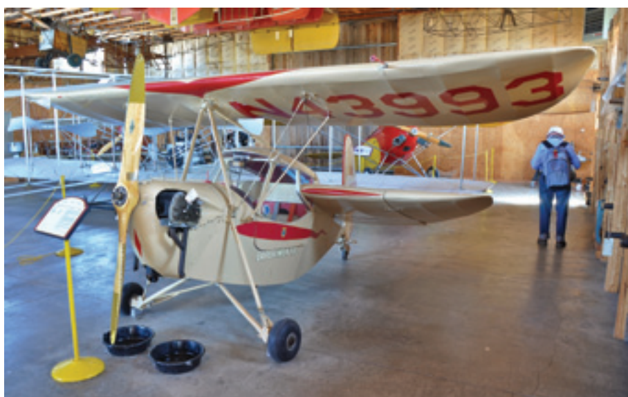
1937 Mignet Pou du Ciel 'Taivaan kirppu', jossa ei ollut korkeusvakaimia eikä polkimia siivittäisohjaukseen, sillä Kirppua lennettiin vain sauvalla ja kaasulla.
