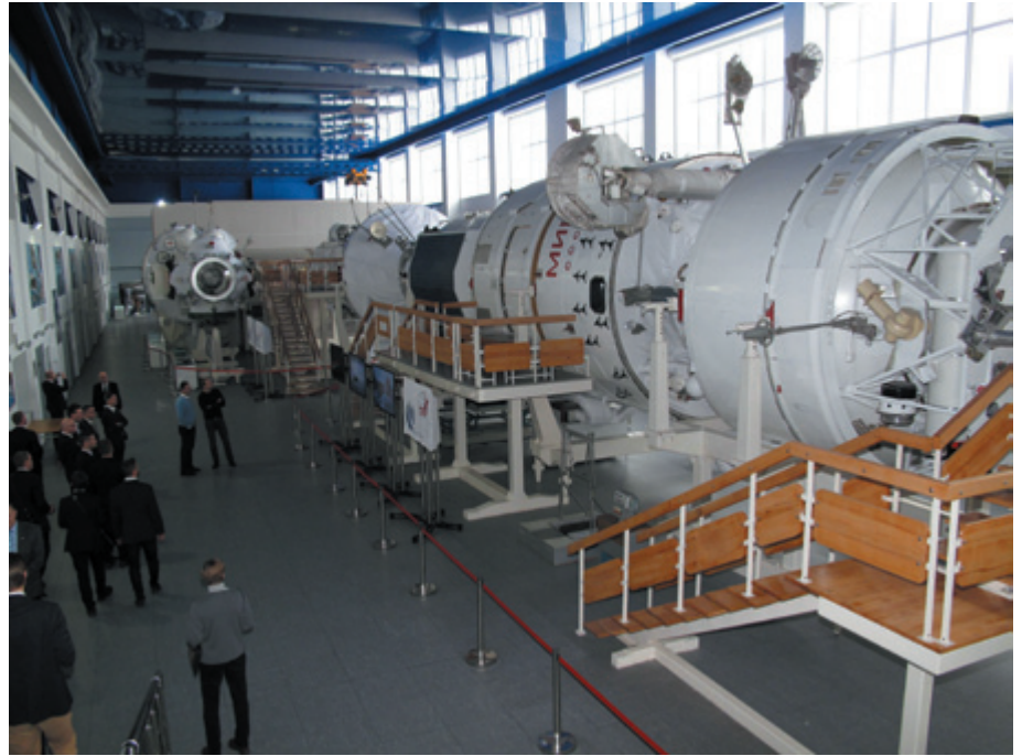
MIR-asemalle lähetettyjen kosmonauttien koulutusta varten rakennettu täysikokoinen harjoitusmoduli...
