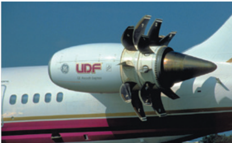
Unducted Fan avoroottori MD-80 testikoneessa. Kuva: Boeing
