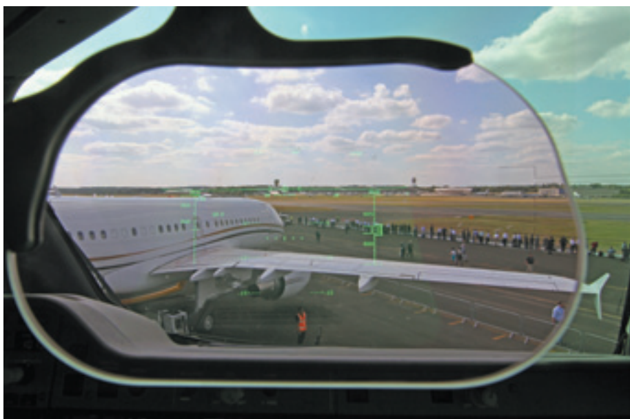
Kuuden 15" LCD-ruudun lisäksi dataa voi valita näkymään myös HUD-näyttöllä.
