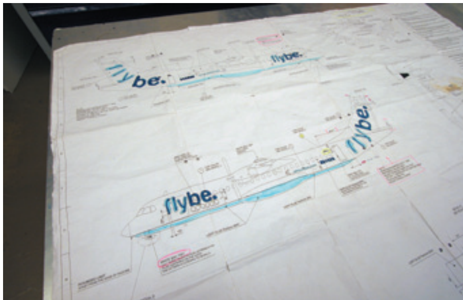
Flyben ATR:n maalauskaavion suunnitelma. Linjat on luotu Englannissa, mutta itse suunnitelma on tehty Finnairin maalaamossa.
