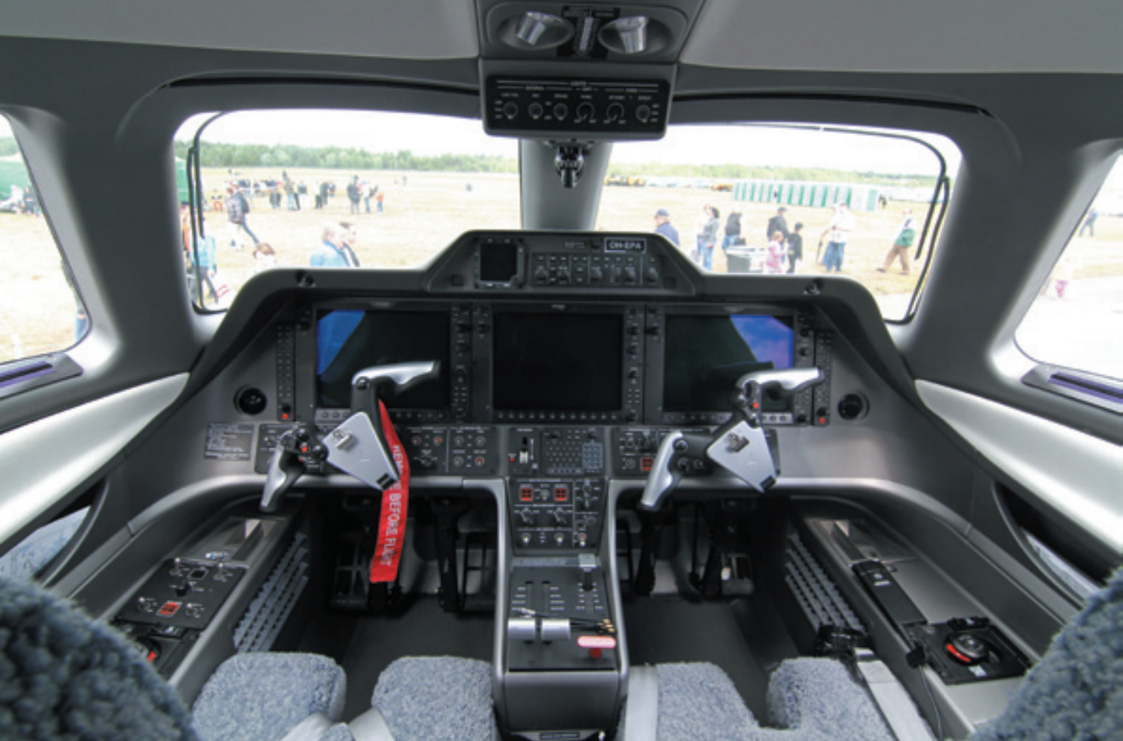
Phenom 100 -koneen ohjaamo on viimeisen päälle tätä päivää. Konetta voidaan operoida yhden ohjaajan miehistöllä, joten suurempi osa järjestelmien hallintalaitteista on sijoitettu vasemmalle puolelle.
