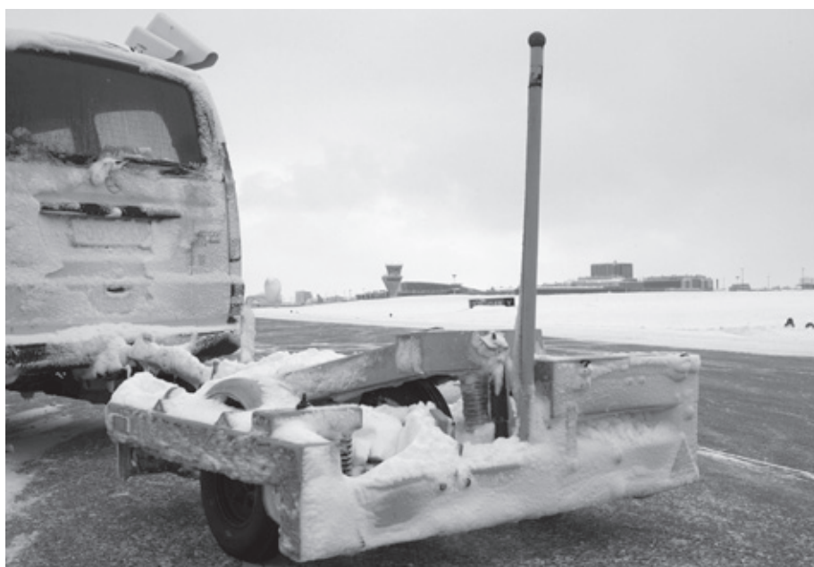
Kitkamittaukseen käytetään erillistä Skiddometer BV-11 -kitkavaunua, jonka korkealla paineella täytetty rengas antureineen mittaa kiitotien liukautta.
