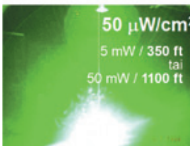
FAA:n tietokonesimulaatio eri korkeuksilla koneeseen osoitettujen lasereiden vaikutuksista visuaalihavaintoihin. (Kuvat: FAA)
