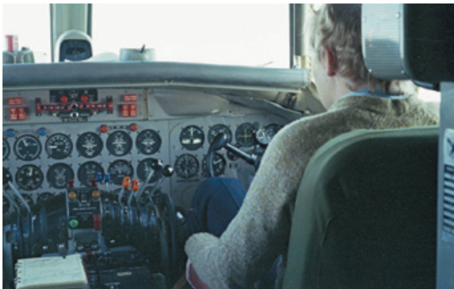
Convair-perämiehen luottotehtäviin kuului perusaskareiden lisäksi muutama nykypilotille vieraampi erikoistoimi. Kapteenin käynnistäessä sitä oikeaa moottoria, laski perämies lapoja kuu-desta yhdeksään tilanteesta riippuen. Ennen vasemman moottorin käynnistämistä kipaisi vikkellä perämies nostamassa portaat ylös ja sulkemassa matkustamon oven. Rullauksen alkaessa paineisti perämies matkustamon veivaamalla ohjaamon oikean ikkunan kiinni. Laskeutumisen jälkeen matkustajien mieliin vaikuttavana kokemuksena on varmasti jäänyt perämiehen taidosta oleellisesti riippuva paineen tasaus eli ikkunan avaus. Kuva ja tehtäväkuvaus: Seppo Jäppinen
