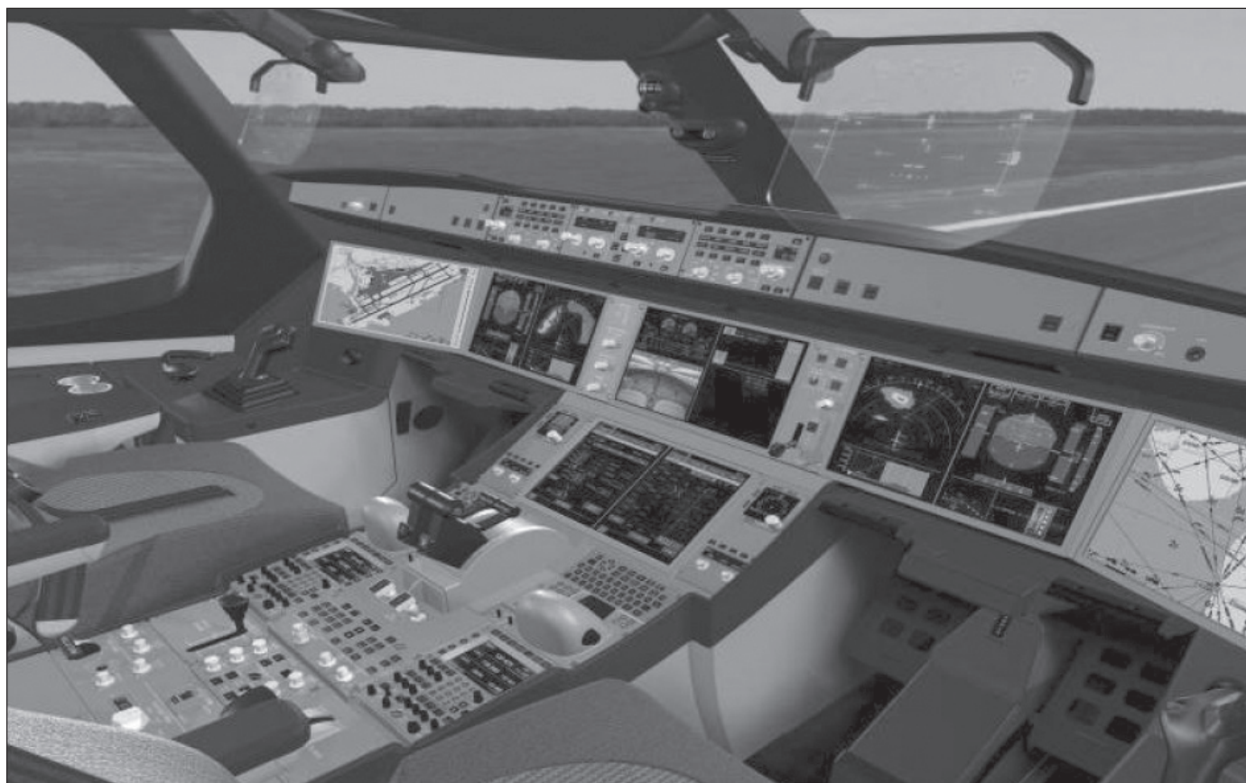
A350 ohjaamo mockup. Tämän näköisenä sitä esiteltiin vuonna 2008, liekö siitä jo muuttunut... Kuva: Airbus
