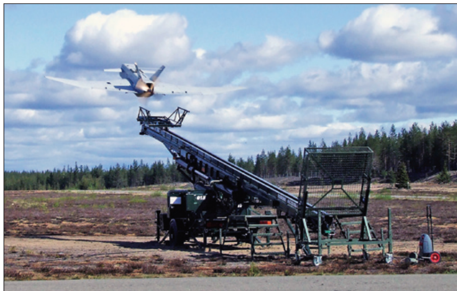
Sagem DS:n Sperwer B:n lentoonlento testilennolle Kemijärven lentopaikalta. Lähtöalustana Robonicin katapultti. Kuva: Petri Erävaara
