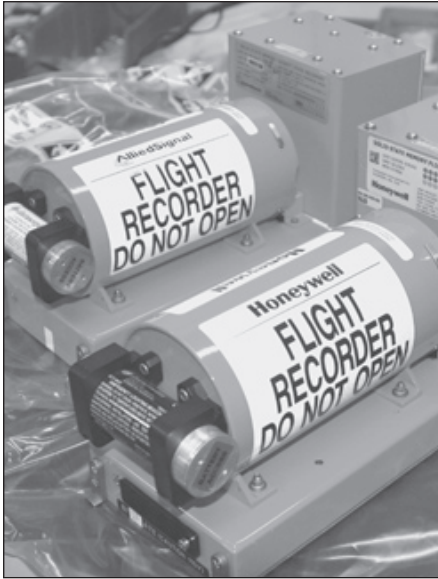
Nykyaikaiset lennontaltiointilaitteet CVR ja DFDR. Kuva: Miikka Hult
