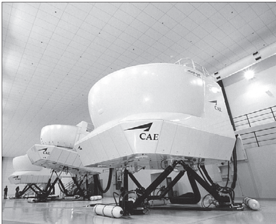
Kookkailla hydraulijaloilla seisovat simulaattorit tekevät tulevaisuudessa tilaa täyselektronisille liikesimulaattoreille, joiden käyttökulut ovat huomattavasti nykyisiä pienemmät.
