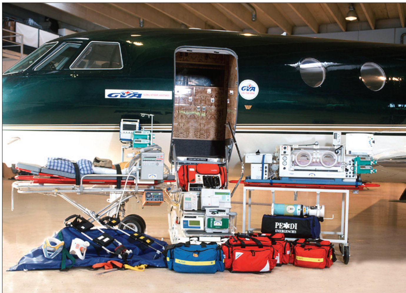
Falcon 20F-5 ambulanssilentoversiossa. Kuvassa mm. keskoskaappi ja osa lääkintävarusteista.
