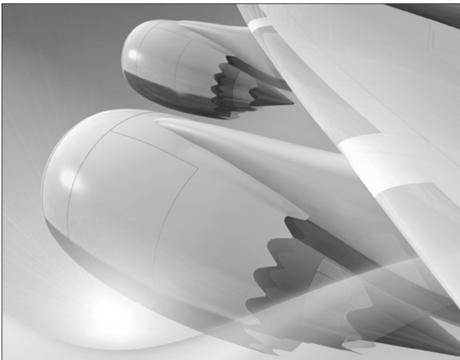
Uusi 747-8 yltää koneperheeseensä verrattuna huomasti parantuneisiin suoritusarvoihin uusilla, paremman ohivirtaussuhteen moottoreilla. Kuvat: Boeing
