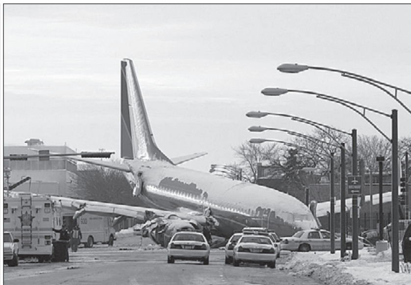
Southwest Airlinesin overrun. Kentällä ei ollut riittävää RESA-aluetta.
