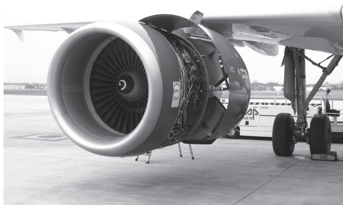
A320:n CFM-moottori pellit auki Helsingin platalla. Moottorivalintaan on oltu varsin tyytyväisiä. Kuva: Kari Voutilainen
