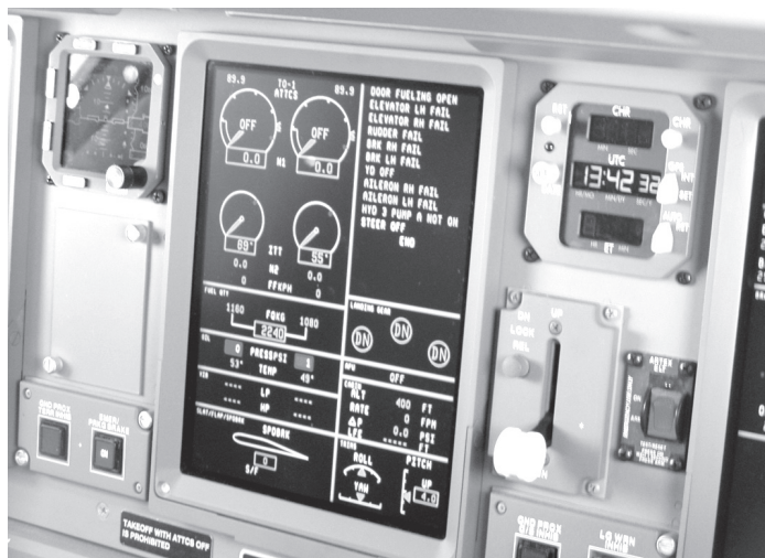
EFIS-näyttö sisältää mm. moottorimittarit ja järjestelmien tilasta kertovia viestejä.
