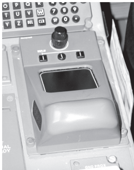
Control Cursor Devicellä ohjataan sormituntumalla EFIS-näyttöjen valikoita.
