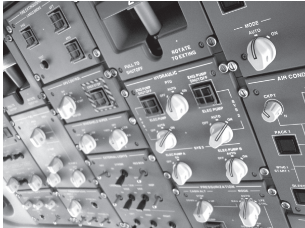
Yläpaneelin kytkinten asettelu on selkeä ja looginen. Valokytkimiin on valittu "eurooppalainen" suunta, ylös-päälle ja alas-pois.
