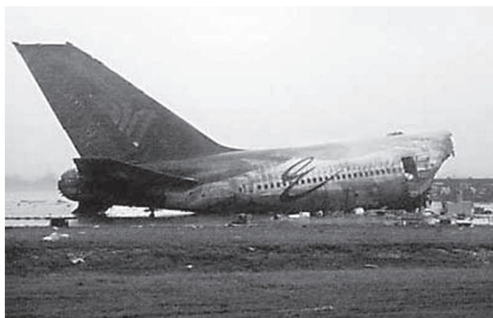
Taipei 31.10.2000. Lento-onlähtö suljetulta kiitotieltä ja törmäys rakennuskalustoon 140 kt nopeudella.
